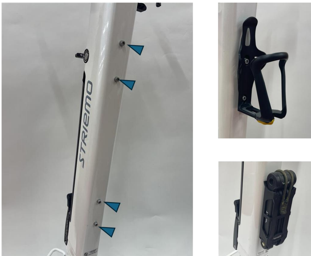
図43 アクセサリボルトと、市販品取り付け例（上：ボトルゲージ、下：ブレードキー）
