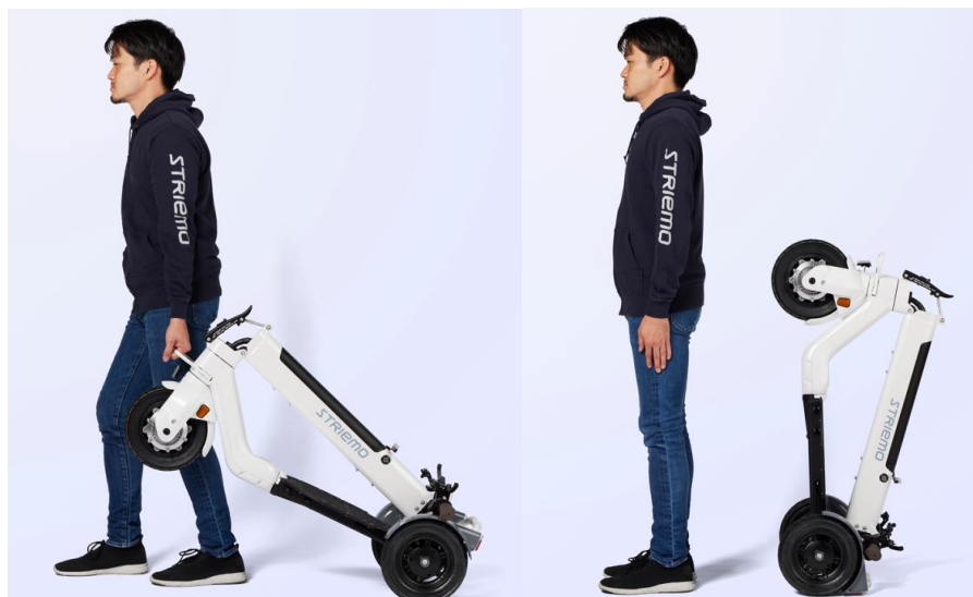
図10 折り畳んで運ぶ様子 および、折り畳んで立てた状態
