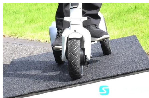
図5 傾いた路面での自立
