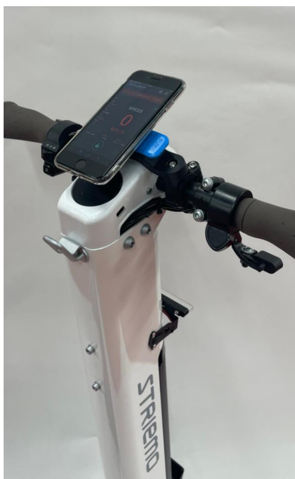
図25 車両へのスマートフォンの取り付け例とダッシュボード画面
